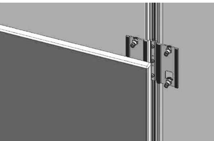
IN ALTO, SEZIONE ORIZZONTALE DEL SISTEMA DI AGGANCIO. A DESTRA, RENDERING ASSONOMETRICO. SOPRA, RENDERING ASSONOMETRICO CON LASTRA.
