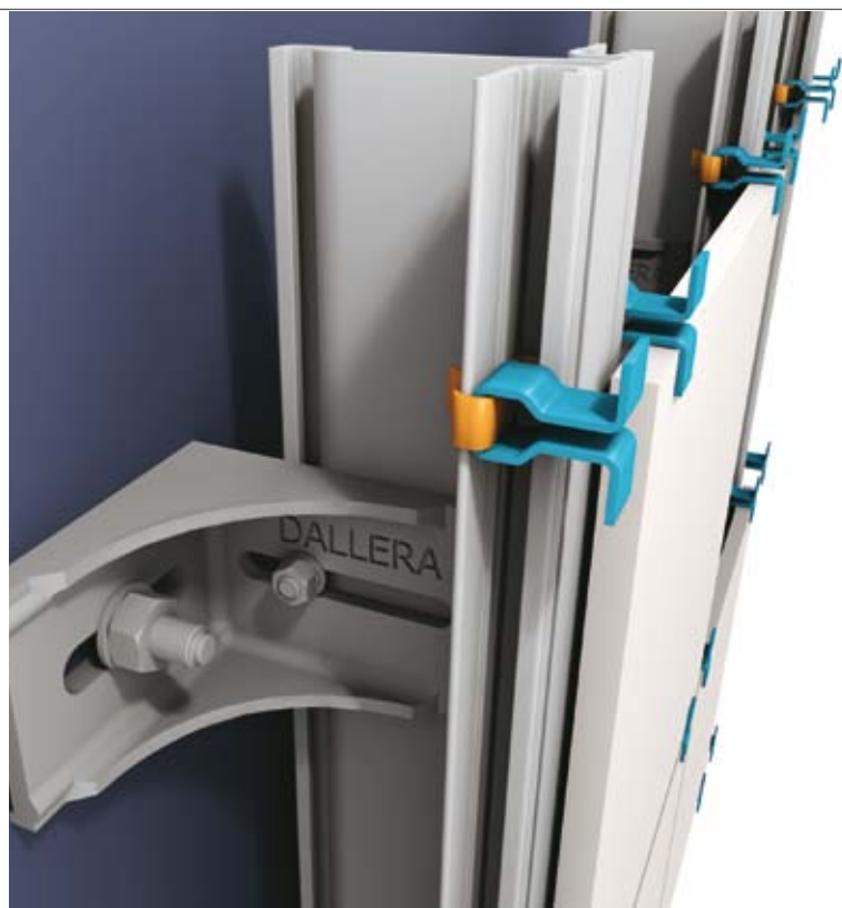
RENDERING ASSONOMETRICO (SOPRA) E SEZIONE VERTICALE (ACCANTO) DEL SISTEMA DI AGGANCIO.
